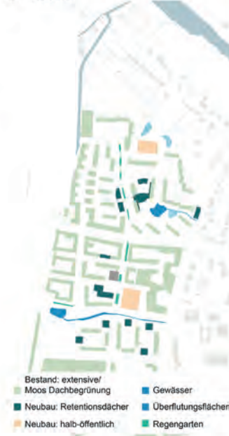
ENTWÄSSERUNGSKONZEPT & NUTZUNG DACHFLÄCHEN M 1:5000
